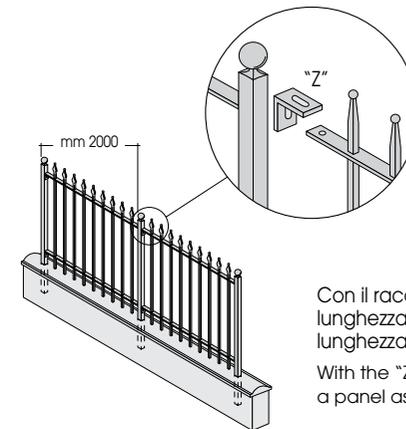
Con il raccordo "Z" si può regolare la lunghezza di un pannello tanto quanto la lunghezza dell'asola del raccordo "Z".
